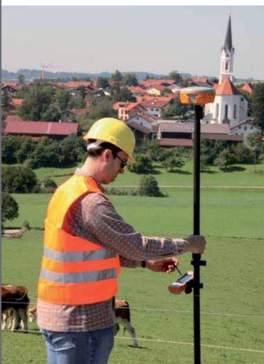
APS-3 Empfänger auf GPS-Stab montiert
