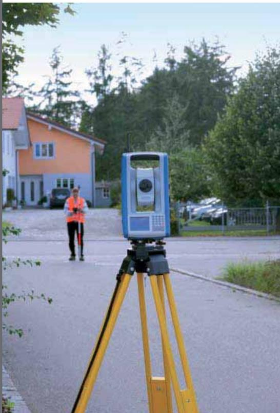
Focus 30 im Ein-Mann-Betrieb mit Funksteuerung
